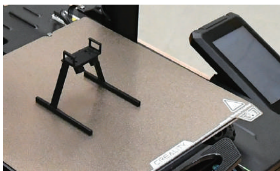
▲3Dプリンターで作成したドローンのランディングギア
